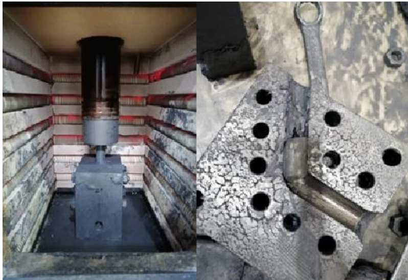
Şekil 6.17. Eş kanallı açılal presin görseli (EKAP).
