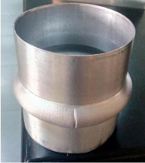
Şekil 2. 7. Tüp hidrolik şekillendirme uygulamalarında yırtılma hata türü
