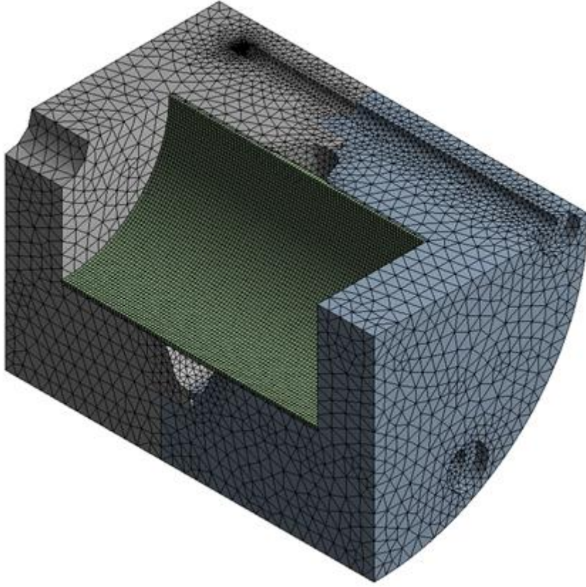
Şekil 3. 12. Hidrolik şişirme ünitesi sonlu elemanlar modeli
