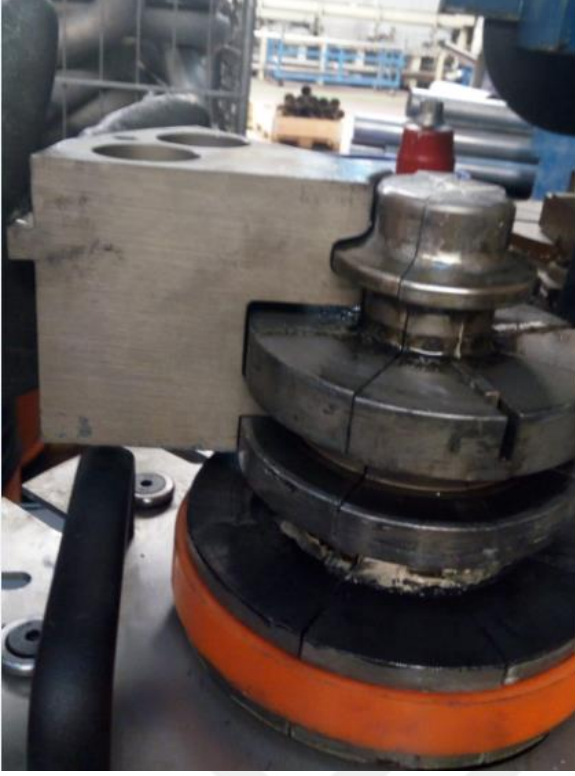
Şekil 3. 4. Vultz açma kalıbın detayları
