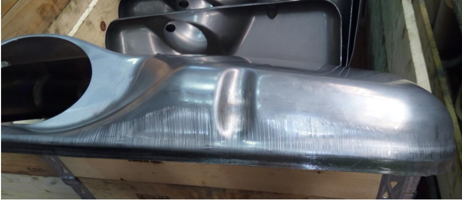
Şekil 1.1. Derin çekme işleminde oluşan çizikler
