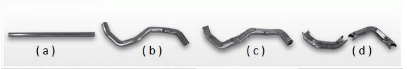
Şekil 2. 8. Tüp hidrolik şekillendirme öncesi parçalara uygulanan ön işlemler [30].
