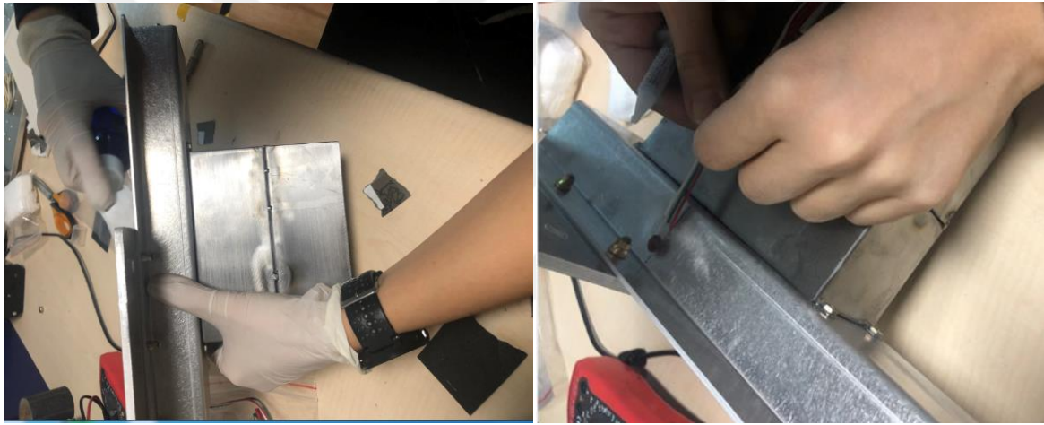
Resim 2.3. Gerinim ölçer uygulaması için yüzey temizliği ve gerinim ölçer uygulaması
