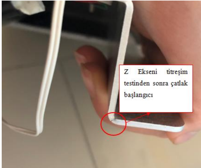
Resim 2.7. Test sonucu braketten oluşan çatlak başlangıcı
