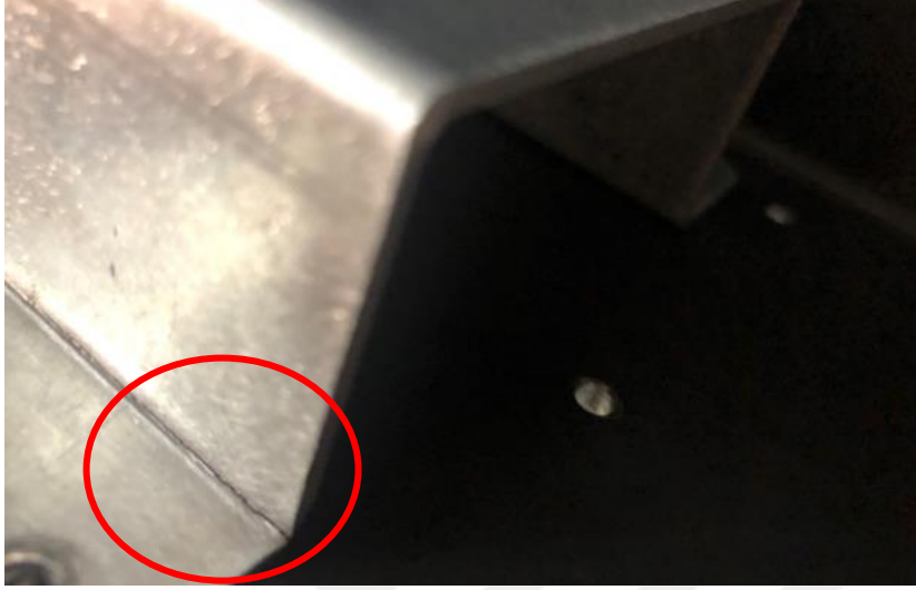
Resim 2.10. X eksenı titreřim testi sonucu atlak ilerlemesi
