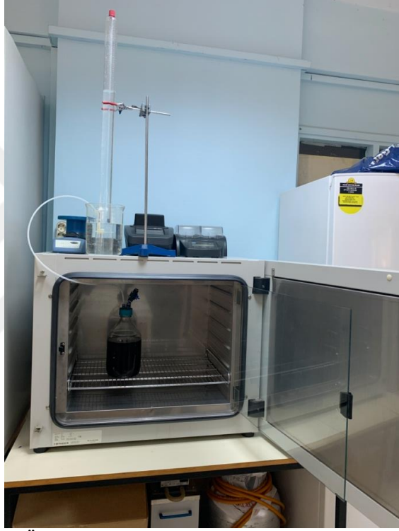
Őekil 3.2. Biyohidrojen Üretiminde Kullanılan Aşı Kùltürü
