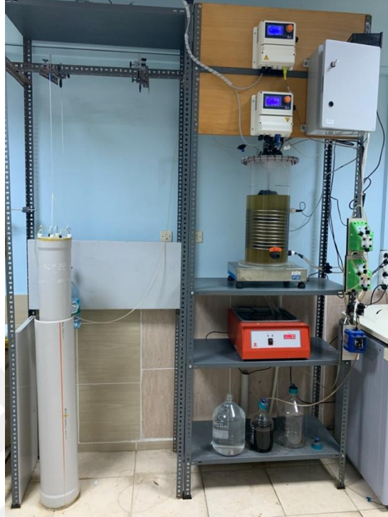
Şekil 3.3. Biyohidrojen Üretiminde kullanılan Reaktör Sistemi
