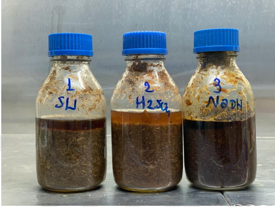
Şekil 3.4. Otoklavda Hidrolize Edilen Miscanthus giganteus Örneklerinin Kimyasal Hidrolizi
