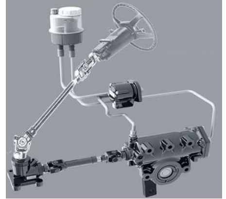
Şekil 2.7. Direksiyon kolunu ve açılı dişli kutusu bağlantısı. ("Ticari Araç Direksiyon Sistemleri", 2019)
