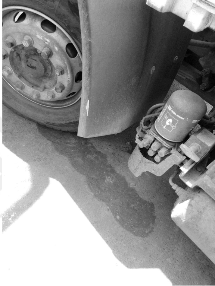
řekil 4.3. Test Kamyonunun pozisyon deęiřimi sonrası zeminde oluřturduęu iz
