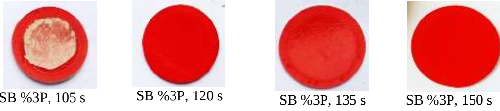
Şekil 4.57: 150 °C’de 105, 120, 135 ve 150 s süre ile kürlenene suni deri numunelerinin 50,000 devir aşınma sonrası görüntüleri (SB: Solvent bazlı pat, P: Pigment).
