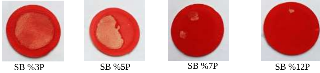
Şekil 4.60: 150 °C’de 120 s süre ile kürlenene suni deri numunelerinin 70,000 devir aşınma sonrası görüntüleri (SB: Solvent bazlı pat, P: Pigment).
