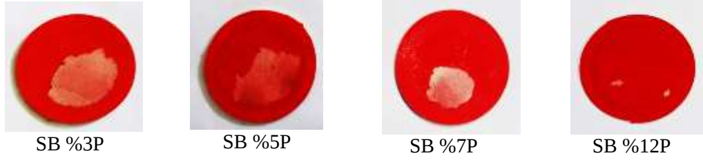
Şekil 4.56: 150 °C’de 90 s süre ile kürlenene suni deri numunelerinin 20,000 devir aşınma sonrası görüntüleri (SB: Solvent bazlı pat, P: Pigment).
