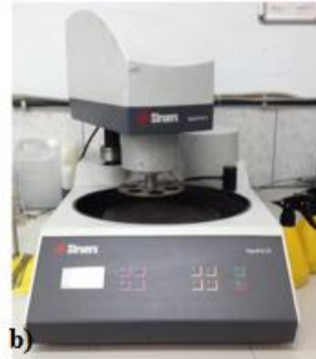
Şekil 5.16 (a) Struers CitoPress-1 kalıplama, (b) Struers Tegra Pol- 21 zımparalama cihazları
