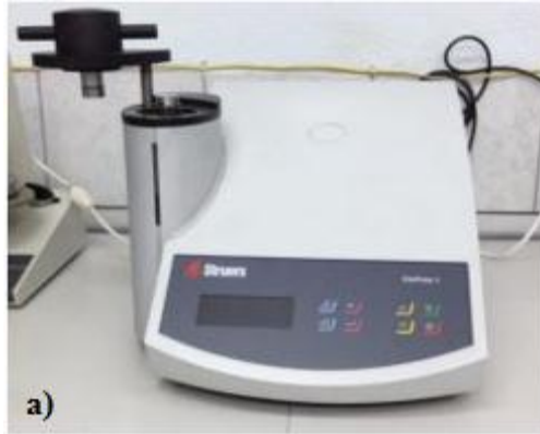
Şekil 5.16 (a) Struers CitoPress-1 kalıplama, (b) Struers Tegra Pol- 21 zımparalama cihazları
