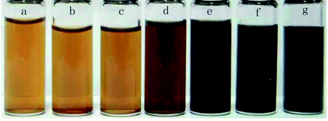
Şekil 1.22. Mikrodalga ısıtma ile indirgenmiş grafen oksit eldesi
