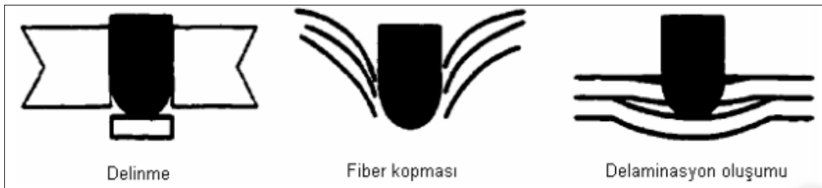
Şekil 5.2. Tabakalı kompozit malzemede balistik darbe anında oluşan hasar mekanizmaları [44]
