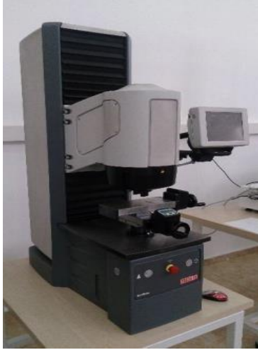
Resim 7.7. Makro sertlik ölçüm cihazı
