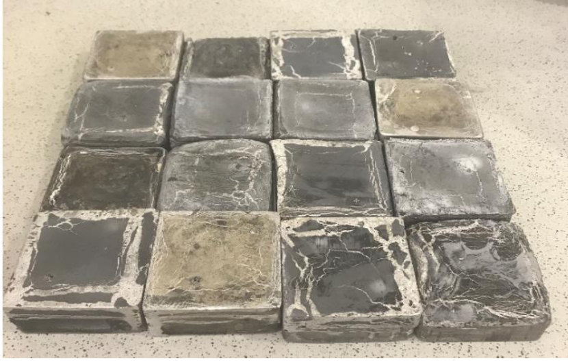
Resim 7.6. Köptürme işlemi sonrası FDKM numuneleri
