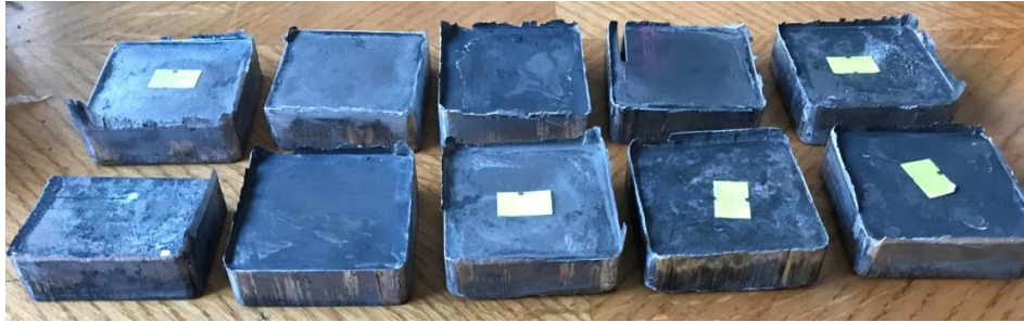
Resim 7.5. Köpürtme işlemi öncesi FDKM numuneleri
