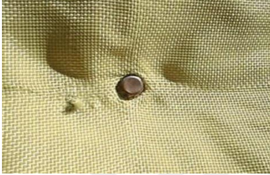
Resim 3.2. Balistik korumada kullanılan Kevlar 29 lifi
