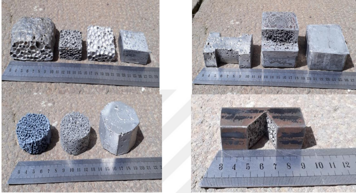
Şekil 6.12. Toz metalürjisi ile üretilen farklı şekillerdeki metalik köpükler
