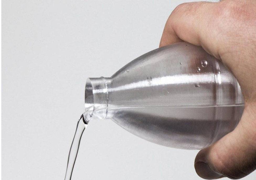
Şekil 2.18. PETG filament ile üretilmiş şişe örneği.
