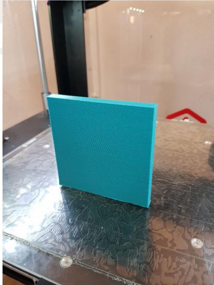
Şekil 3.10. ABS filamentten üretilen parça.
