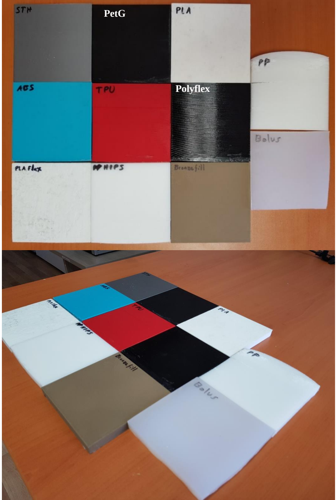
Şekil 3.20. 10 Farklı filamentten üretilen parçalar ve standart bolus malzemesi.
