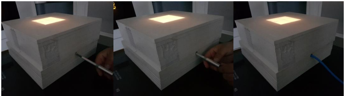
Şekil 3.24. Katı su fantomlarının içerisine iyon odasının yerleştirilmesi.
