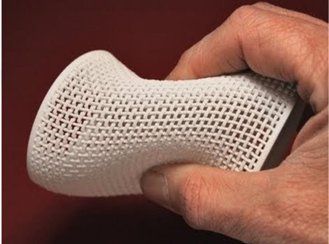
Şekil 2.20. PLA flex filament ile yazdırılmış parça.
