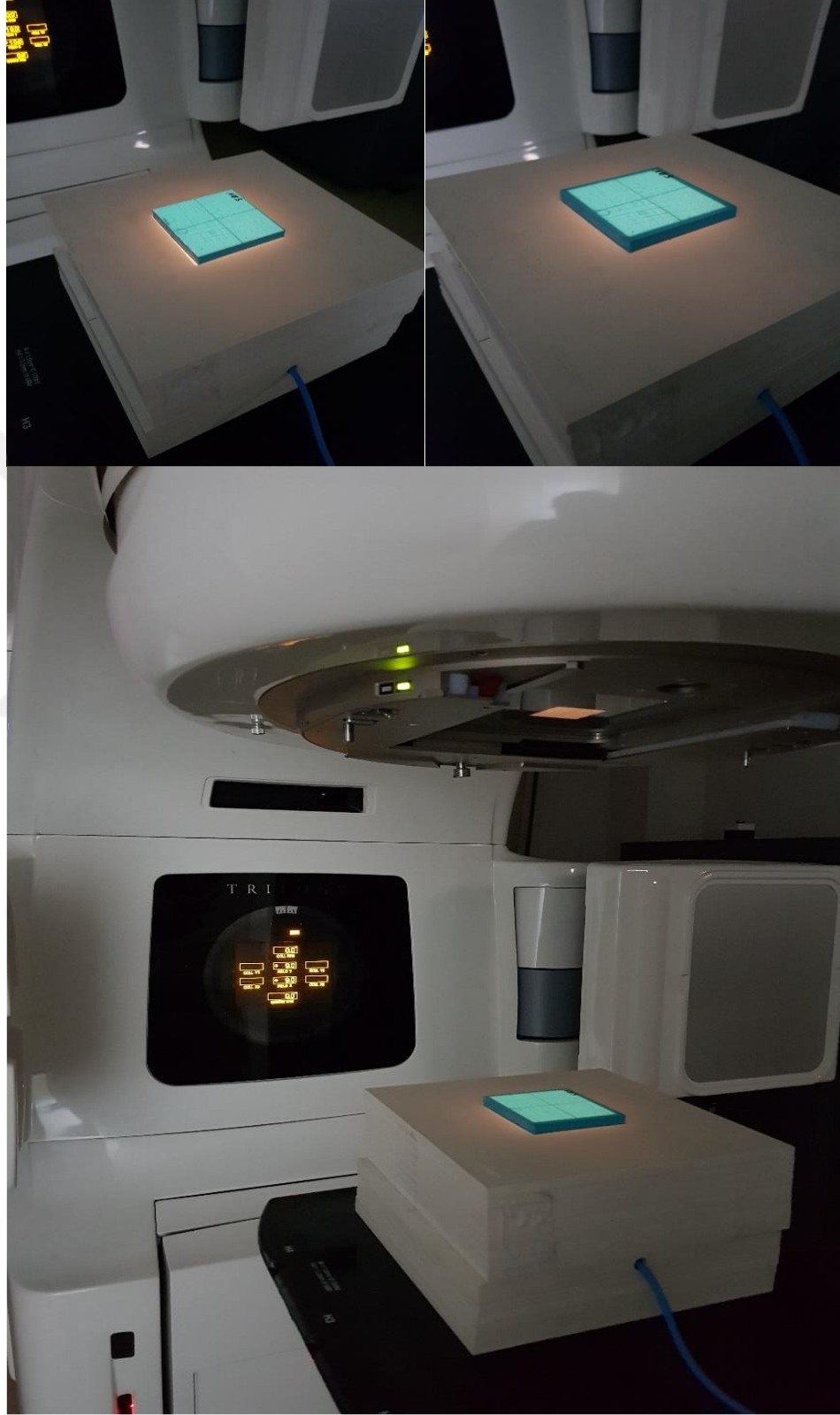
Şekil 3.27. ABS filamentten üretilen parçanın ölçümleri için hazırlık.
