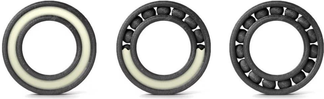
Şekil 2.17. HIPS filament ile yazdırılmış parça örneği.
