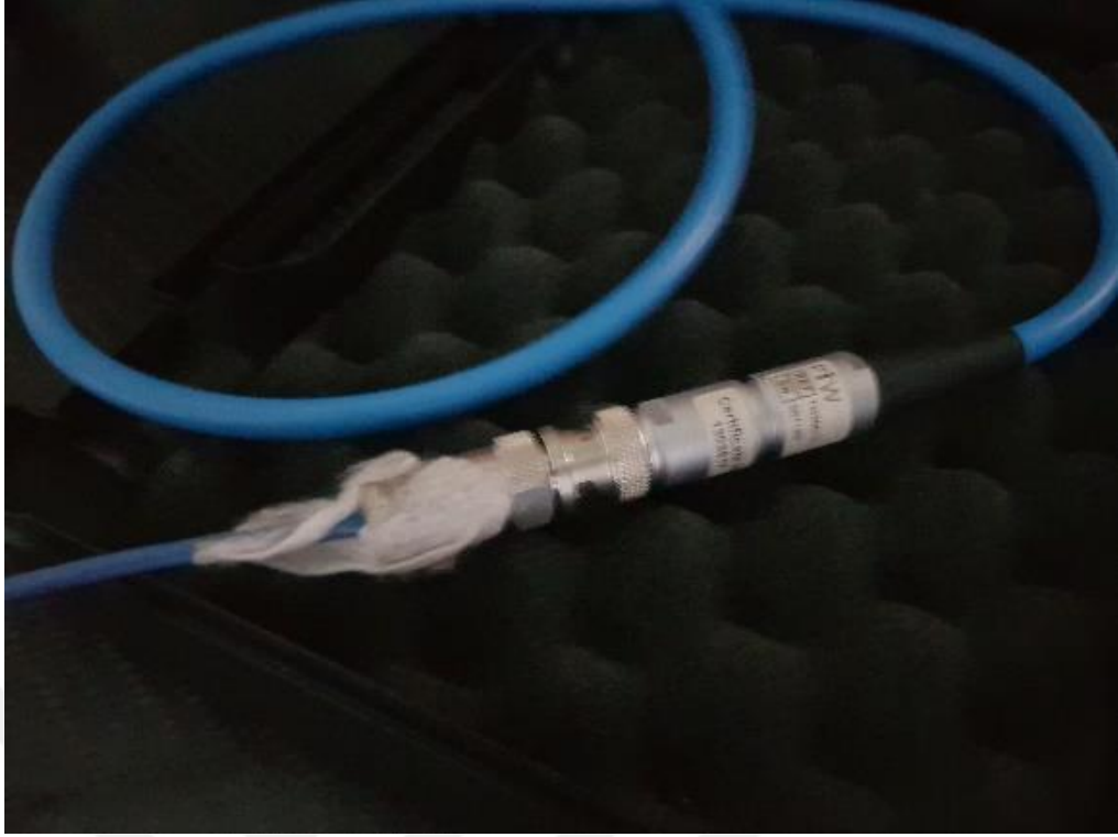
Şekil 3.25. İyon odası ile elektrometrenin bağlantısı.
