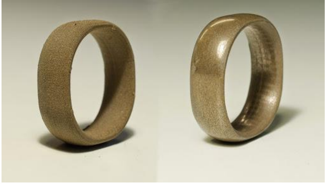
Şekil 2.16. Bronzfill filament ile yazdırılmış parça örneği.
