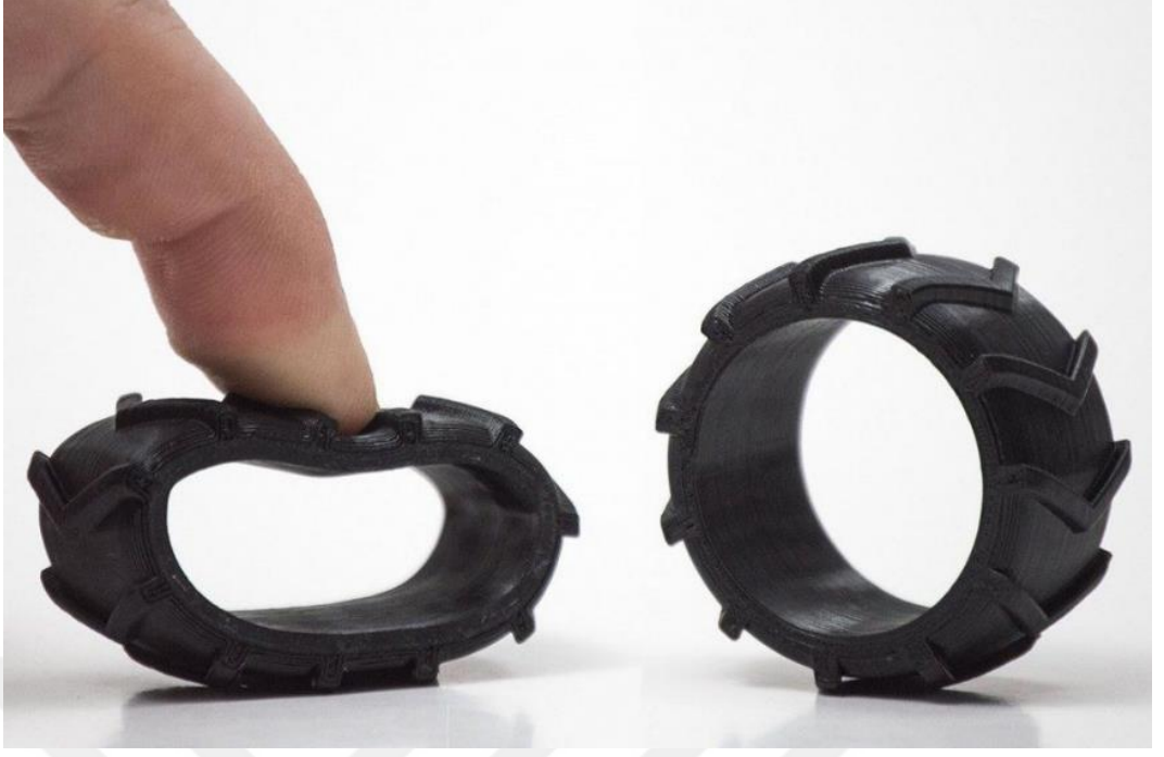
Şekil 2.24. TPU filament ile yazdırılmış parça örneği.
