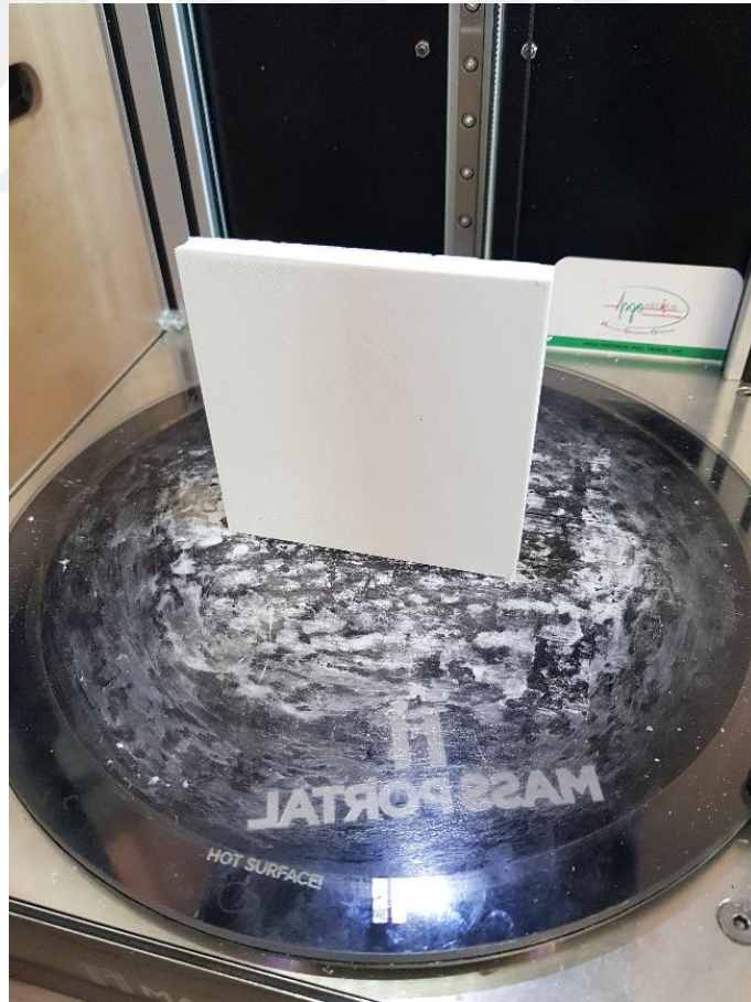
Şekil 3.15. PLAflex filamentten üretilen parça.
