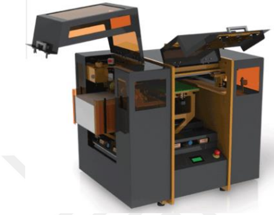
Şekil 2.12. LOM yazıcı örneği.
