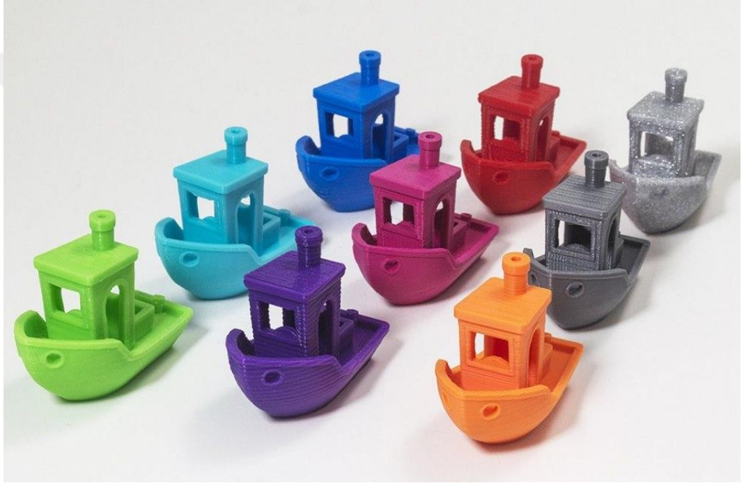
Şekil 2.19. PLA filament ile yazdırılmış parça örnekleri.
