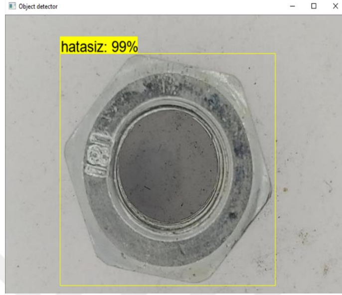
Şekil 68: Hatasız Metal Somunun Resim Üzerinde %99 Doğrulukla Tespit ve Sınıflandırılması
