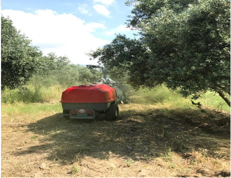
Şekil 3.15. Elektrostatik ilaçlama tekniği ile damla analizleri ve kaplama oranları testlerinden bir görünüm.
