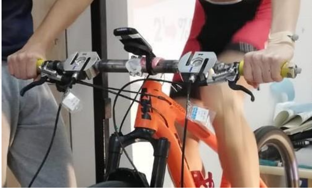
Şekil 16. Bisiklet Gidonuna Montajlanmış S-Tipi Yük Hücresi
