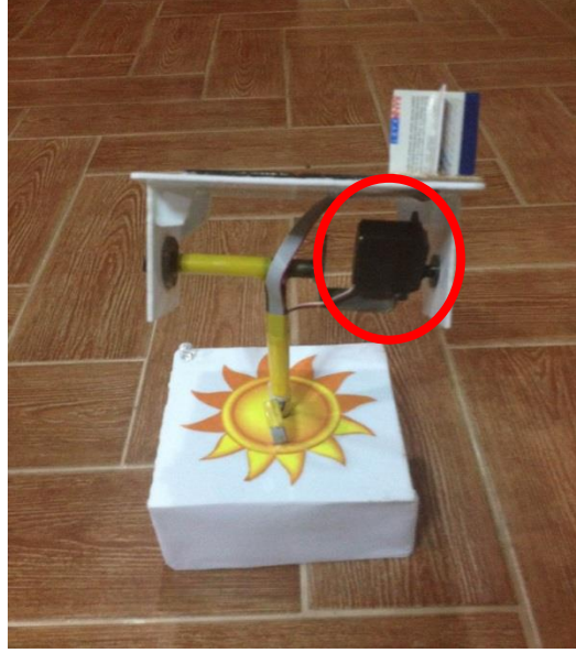
Şekil 5.10 Güneş takip sisteminin arka görünüşü
