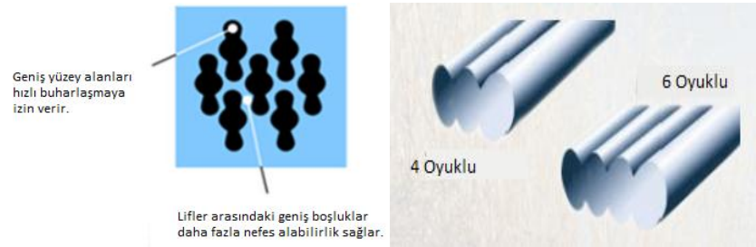
Şekil 1.16. Farklı kesitlerde coolmax lifleri [20].
