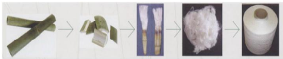
Şekil 1.33. Doğal Bambu Lifinin Üretim Prosesi.
