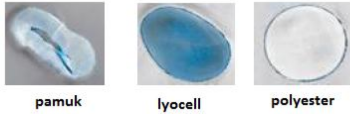
Şekil 1.30. Pamuk, lyocell (Tencel), polyester liflerinin kesit şekli [36].
