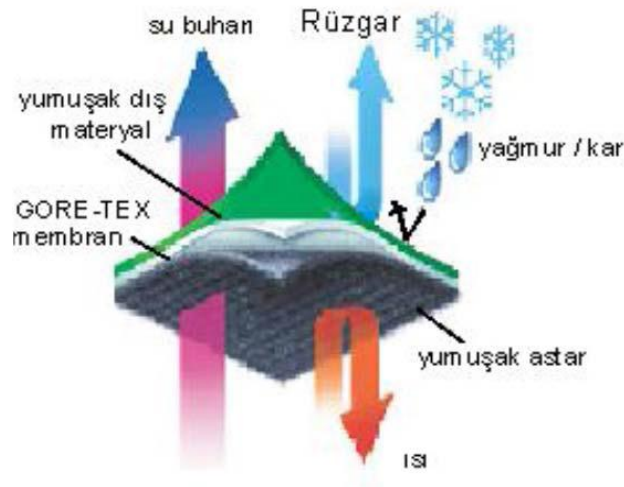
Şekil 1.40. Konfor amaçlı üretilen çok katmanlı kumaşlar [3].
