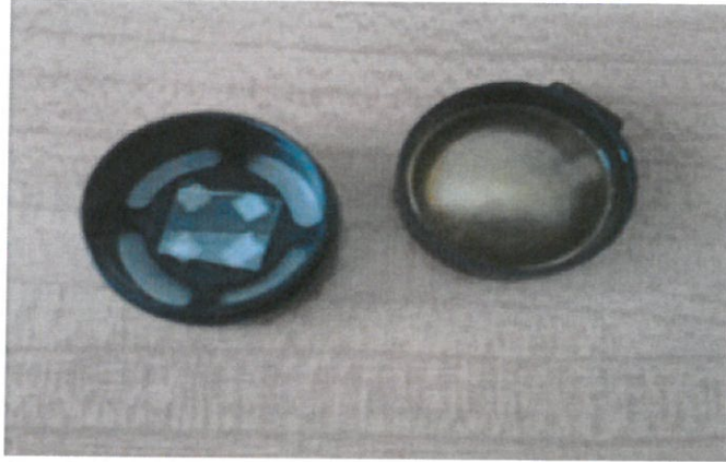
Şekil 2.15. Radamon kazıma iz dedektörü iç yapısı
