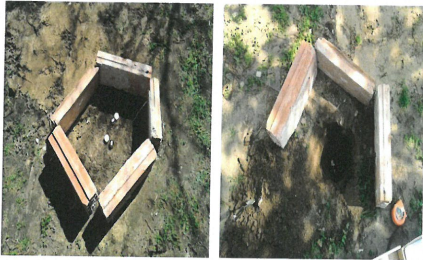
Şekil 2.17. Toprak gazında radon ve toron ölçüm düzeneği
