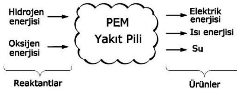
Şekil 1.4 Yakıt pili serbest enerji diyagramı
