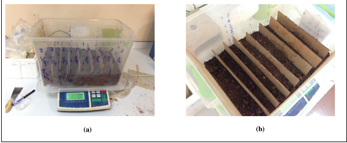
Şekil 3.9. Toprakta Bozulma Deneylei için Kullanılan Düzenek (a) Önden Görünüş, (b) Üstten Görünüş
