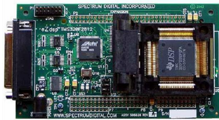
Şekil 3.18. eZdsp geliştirme kartı
