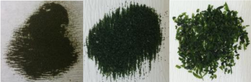
Şekil 3.3. Enteromorpha spp. bitkisinin farklı partikül çaplarına ait kurutulmuş örnekleri (solda: 150 mesh altı, ortada: 150 mesh, sağda: 30/35 mesh)
