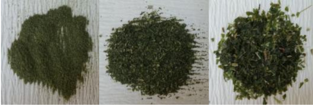
Şekil 3.2. Potamogeton crispus bitkisinin farklı partikül çaplarına ait kurutulmuş örnekleri (solda: 150 mesh altı, ortada: 150 mesh, sağda: 30/35 mesh)
