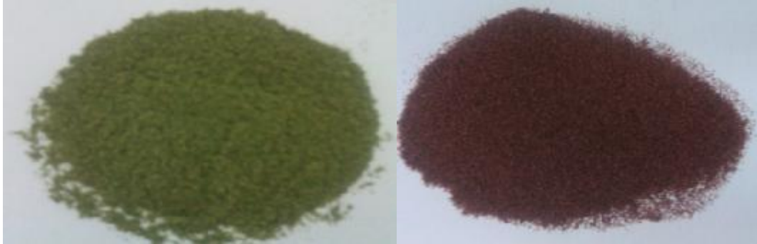
Şekil 4.19 Potamogeton crispus bitkisinin adsorpsiyon öncesi (solda) ve adsorpsiyon sonrası (sağda) örnekleri (0.25mM, 150 mesh altı)
