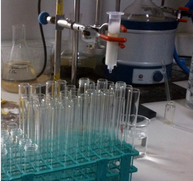
Şekil 10: Poliamid kolon kromatografisi deney düzeneği
