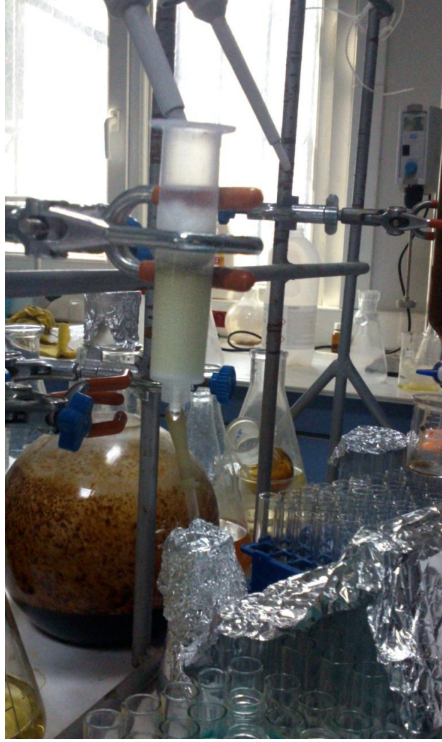
Şekil 11: RP Kolon kromatografisi deney düzeneği
