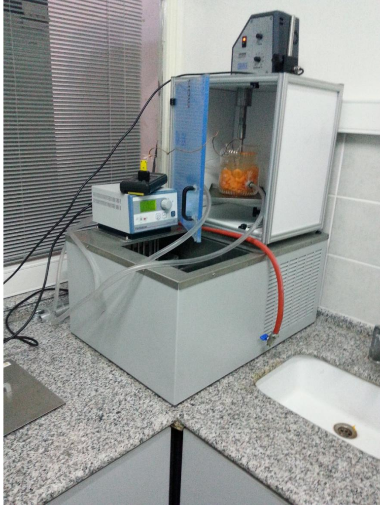
Ek 30. Ultrasonik prob ve soğutma amacıyla kullanılan su banyosu
