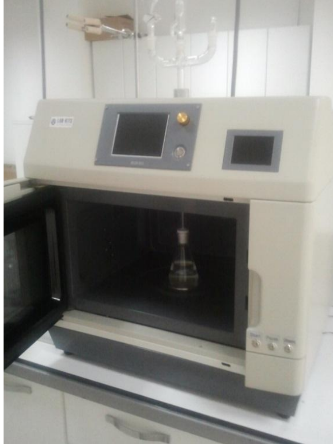
Şekil 3.18. Deneysel çalışmalarda mikrodalga ısıtma için kullanılan ultrasonik/mikrodalga reaktörü.
