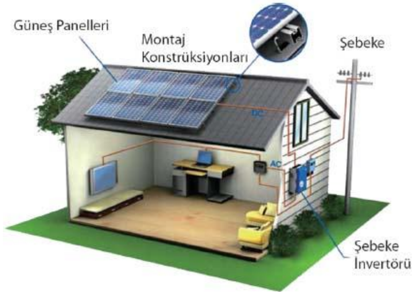
Şekil 2.14. Konut için Şebekeye Bağlı Fotovoltaik Sistem
