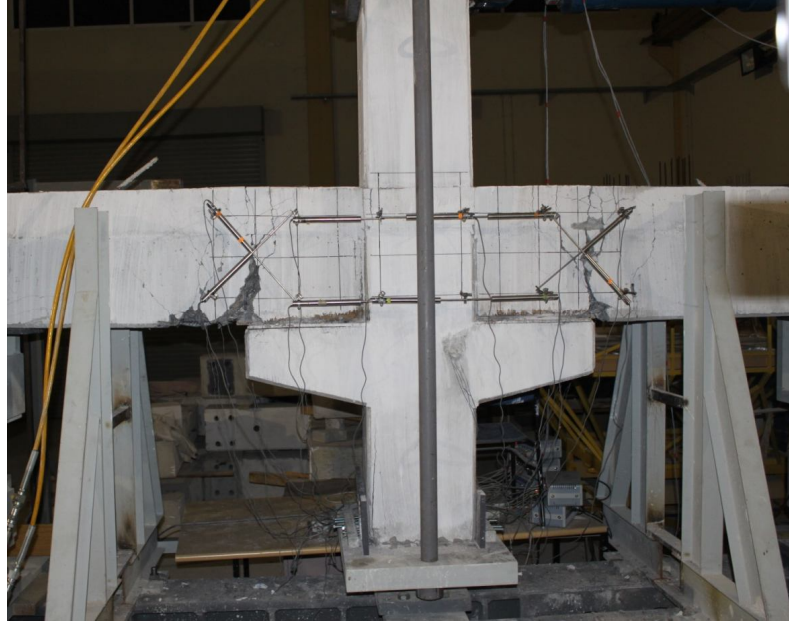
Şekil 4.10 N1 numunesinde % 3,5 ötelenme oranındaki hasar dağılımı
