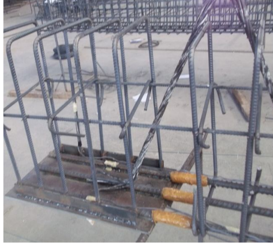
Şekil 3.7 N2 numunesinde donatı-plaka kaynak bitiminden itibaren aderans bozulma boyunun bırakılması
