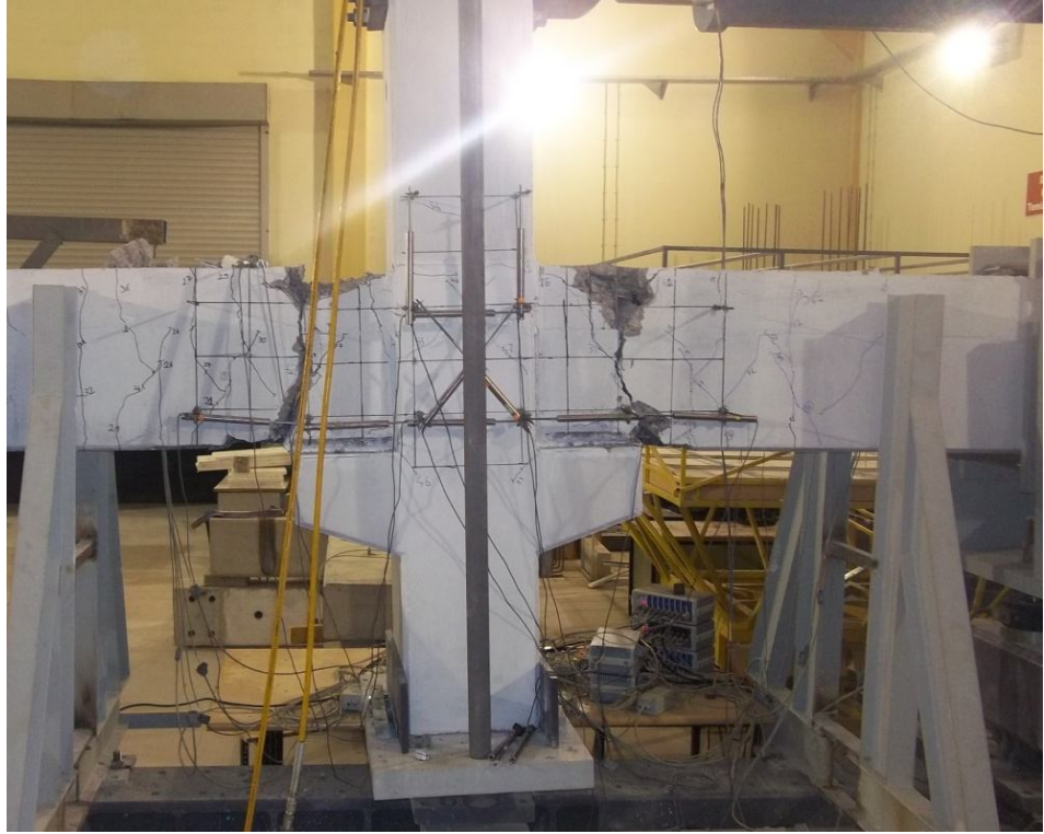
Şekil 4.21 N3 numunesinin % 3,5 ötelenme oranındaki hasar durumu
