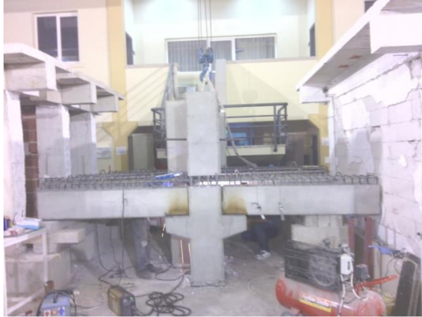
Şekil B.8 Kirişlerin kısa konsol plakalarına kaynaklanması
