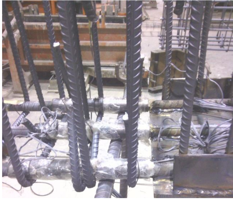
Şekil 3.11 N5 numunesinde çelik kılıf kullanılarak aderans bozulma boyu bırakılması
