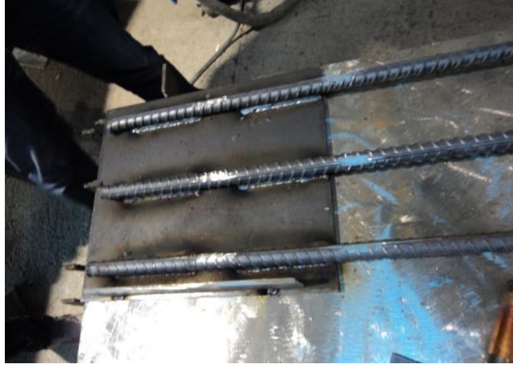
Şekil B.1 Kiriş boyuna donatılarının plakaya kaynaklanması
