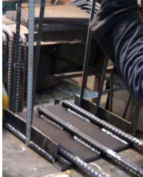
Şekil B.2 Kiriş etriyelerinin ek plakalara kaynaklanması
