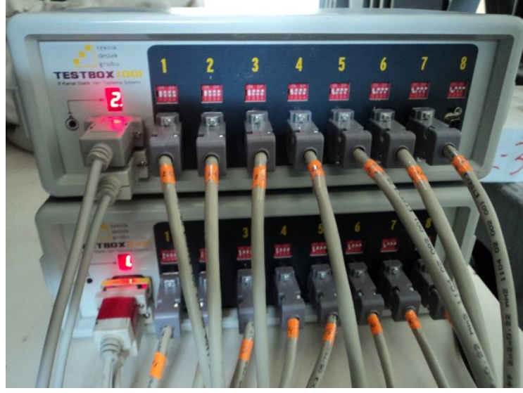
Şekil 3.24 Gerinim pullarının ve yer değıştirme ölçerlerin veri toplama sistemine bağlanması
