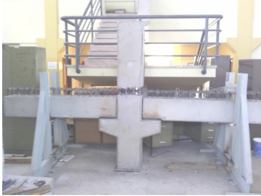
Şekil B.7 Kolonun düşey konuma getirilmesi ve kirişlerin mesnetlenmesi
