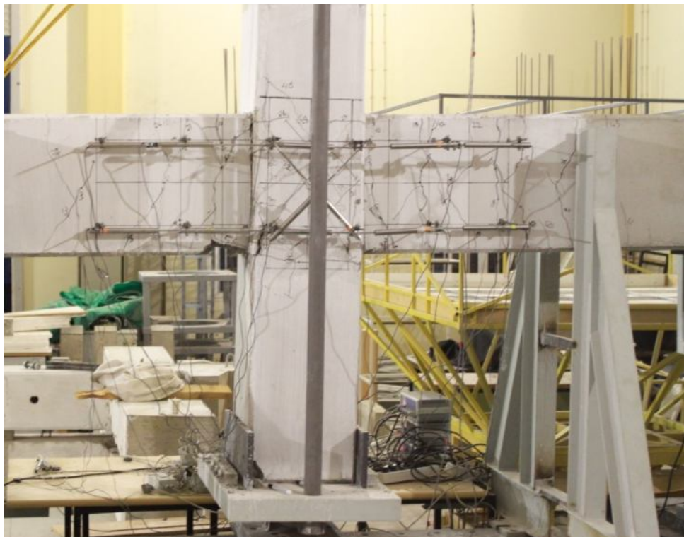
Şekil 4.3 N0 numunesinin % 2,75 ötelenme oranındaki hasar durumu
