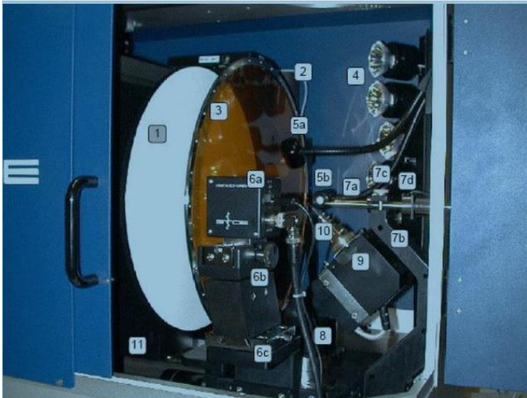
Şekil 5.2. STOE IPDS II difraktometresinin iç kısım görünümü.
