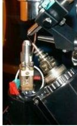
Şekil 5.4. Gonyometre başlığı ve difraktometre içindeki konumu.
