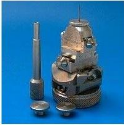
Şekil 5.4. Gonyometre başlığı ve difraktometre içindeki konumu.
