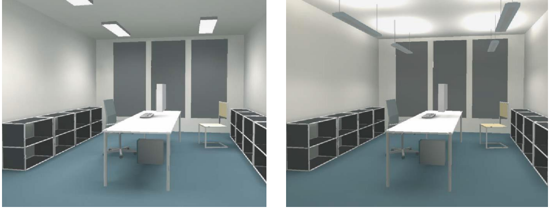
Şekil 3.9. (Soldan sağa) Doğrudan ve Dolaylı Yapay Aydınlatmanın Tek Başlarına Kullanımlarındaki Etkilerini Gösteren Temsili Resim [85].
