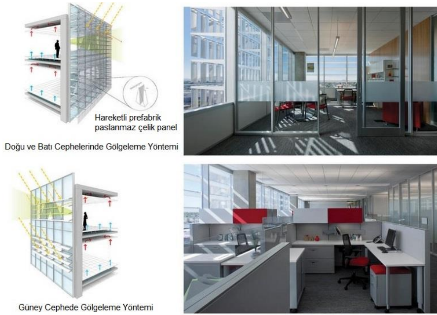
Şekil 3.12. Doğu, Batı ve Güney Cepheler için Dıştan Pasif Gölgeleme Yöntemleri (Chandler City Hall, Arizona, 2012, ABD) 73
