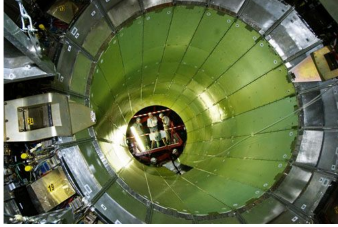
Şekil 3.6: Elektromanyetik kalorimetre cam gibi şeffaf fakat demirden daha ağır olan kurşun tungsten kristallerinden oluşmuştur [23].
