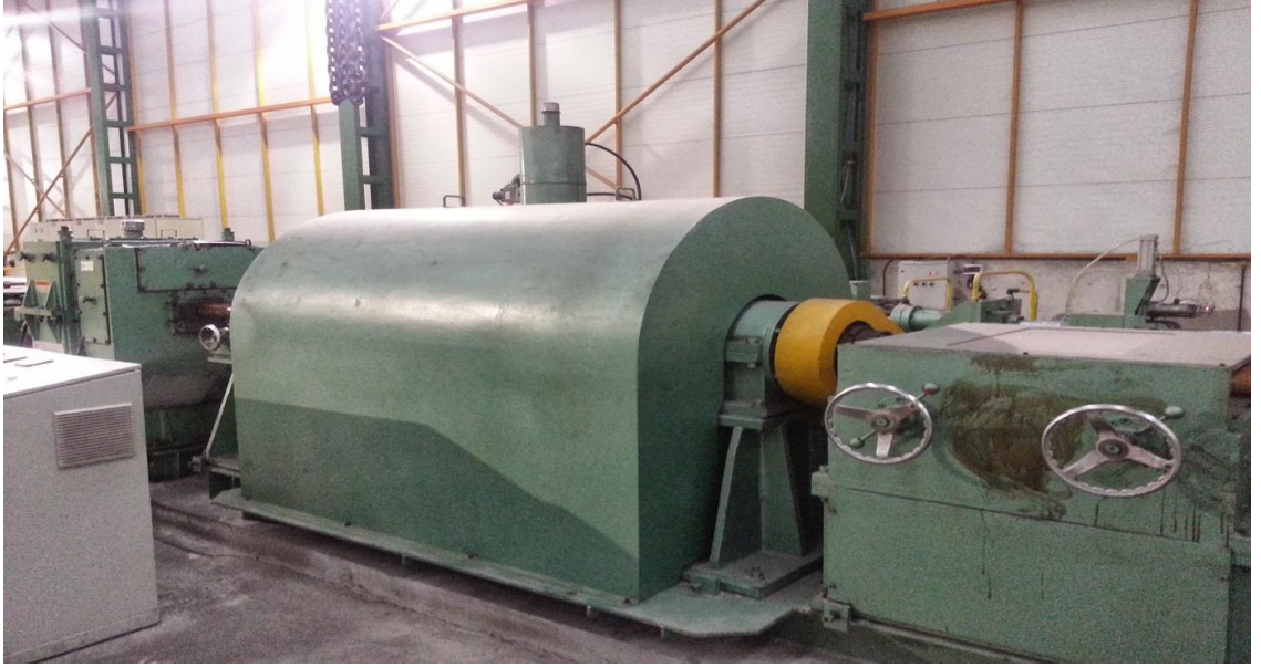
Şekil 3.4. Yüzey temizleme makinesinin resmi
