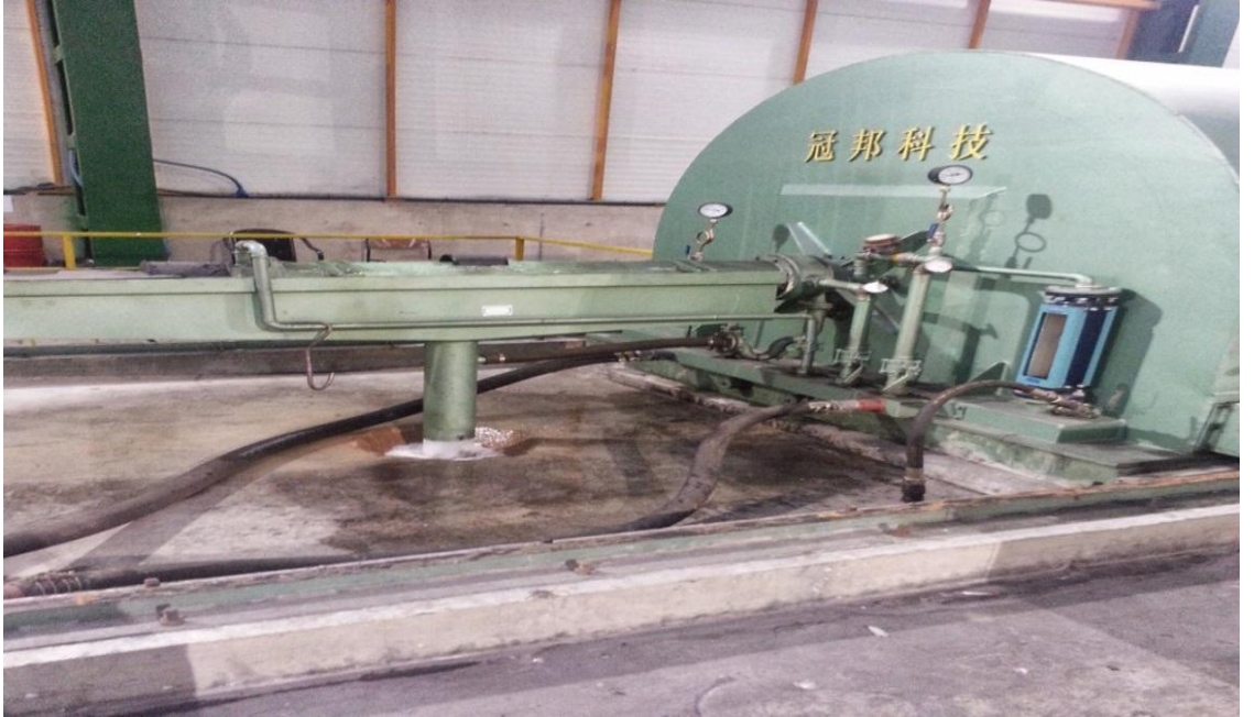
Şekil 3.5. Boru ovalama makinesinin (pilger) resmi
