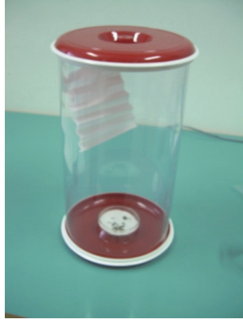
Şekil 6.1 Salkım güvesi dişilerinin yumurta bırakması için PVC rulodan yapılmış yetiştirme kapları.
