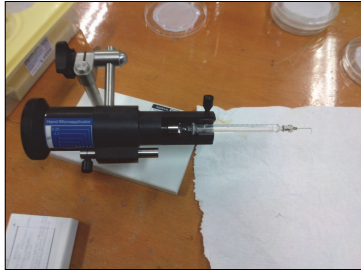
Şekil 6.8 Burkard marka elle çalışır mikro aplikatör (Hand-operated microapplicator).
