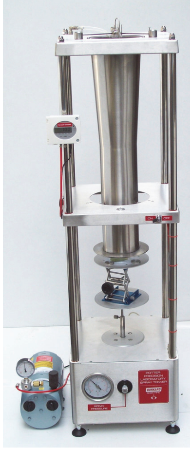
Şekil 6.11 Manuel yüklemeli ilaçlama kulesi ve hava kompresörü.
