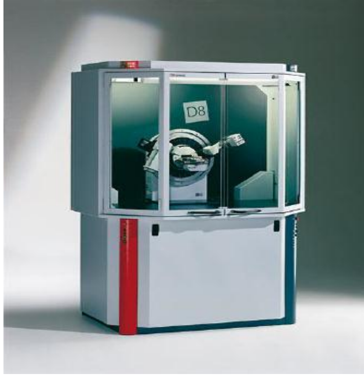
Şekil 3.9. X-Işınları Toz Difraksiyon Ölçümleri (XRD) İçin Kullanılan Bruker AXS D8 Advance Tipi Difraktometre.
