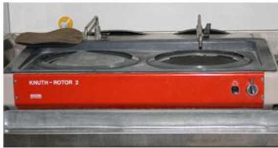
Şekil 3.7: Su soğutmalı zımparalama cihazı
