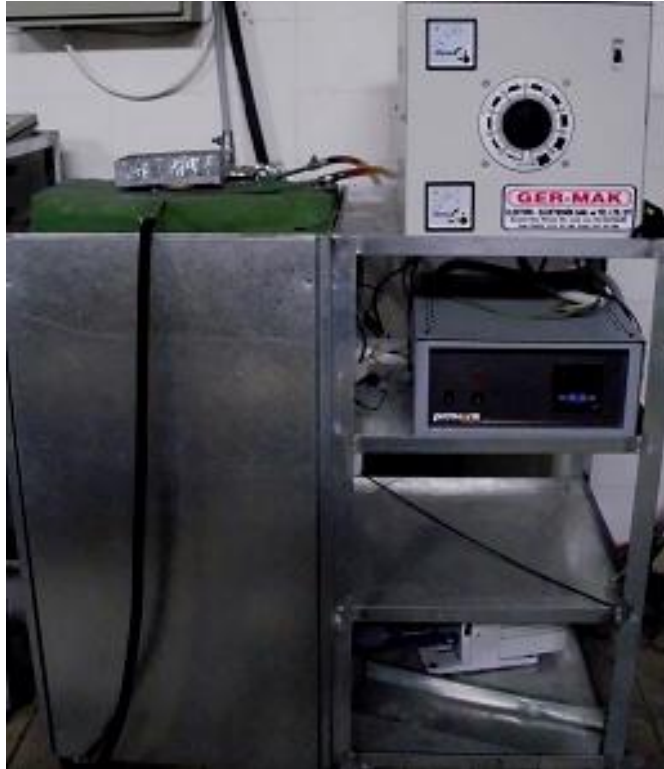
Şekil 3.4. Vakumlu eritme fırınının fotoğrafı.
