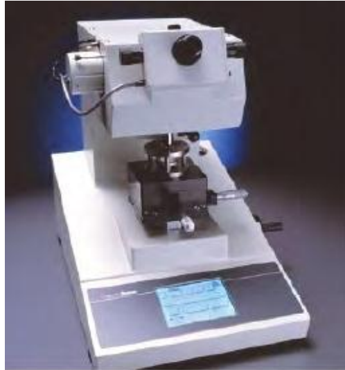
Şekil 3.14. Sertlik ölçüm cihazı.
