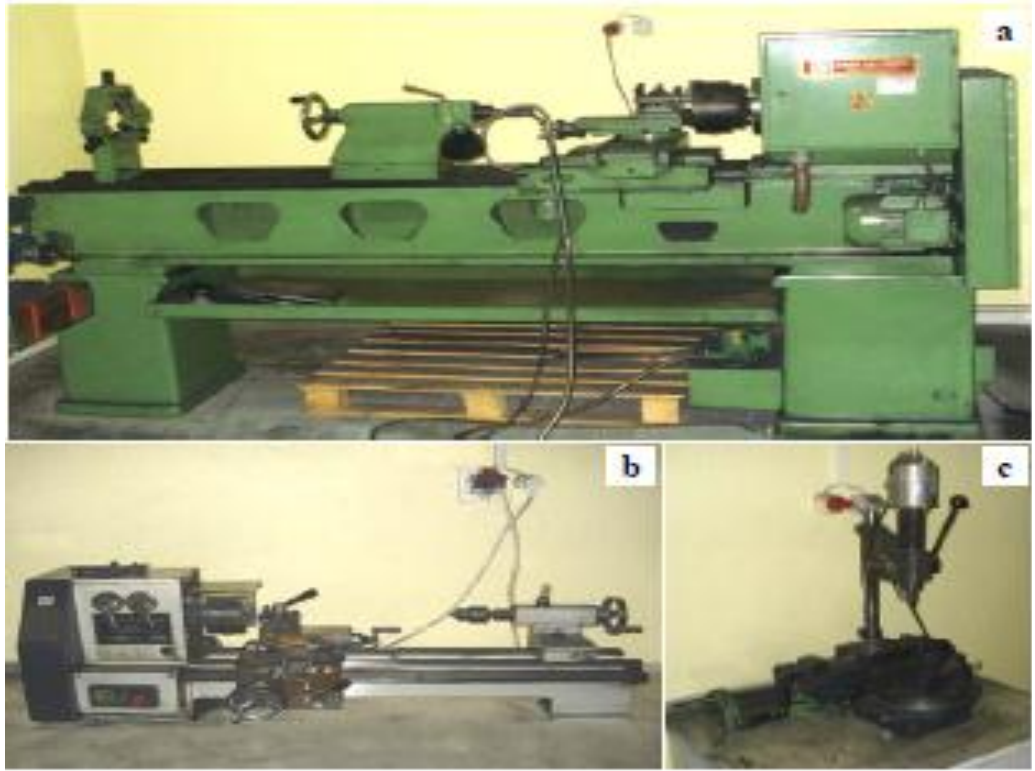
Şekil 3.2. Grafitin işlenmesinde kullanılan a) büyük torna, b)küçük torna ve c)yönlü matkap.
