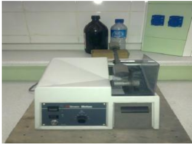
Şekil 3.5. Struers Minitom numune kesme cihazı [20].
