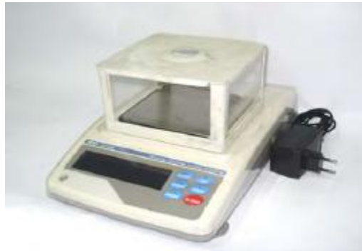
Şekil 3.3. AND GX-600 tipi hassas terazi
