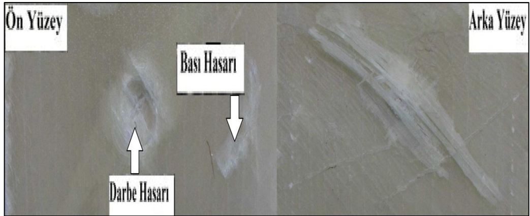
Şekil 3.12 BBB3’de hasar gelişmesi
