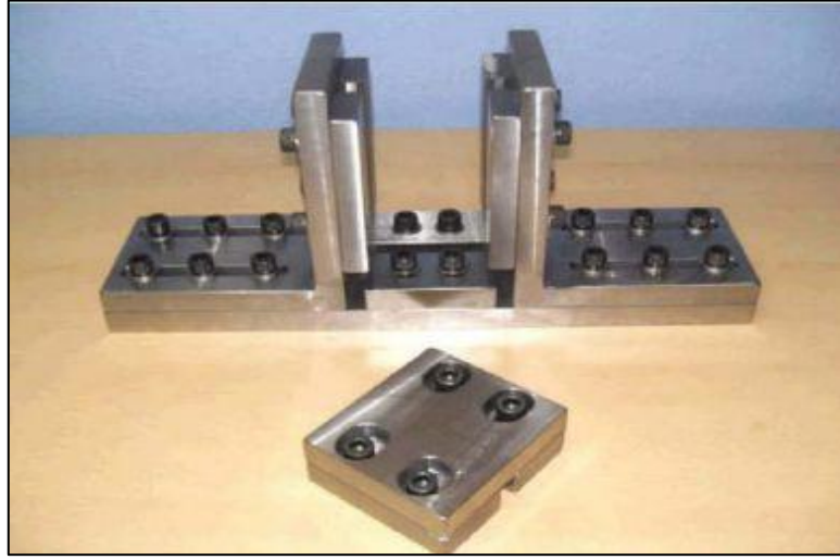
řekil 2.2 ASTM D 7137 aparatı (Aktař ve diđer., 2009)
