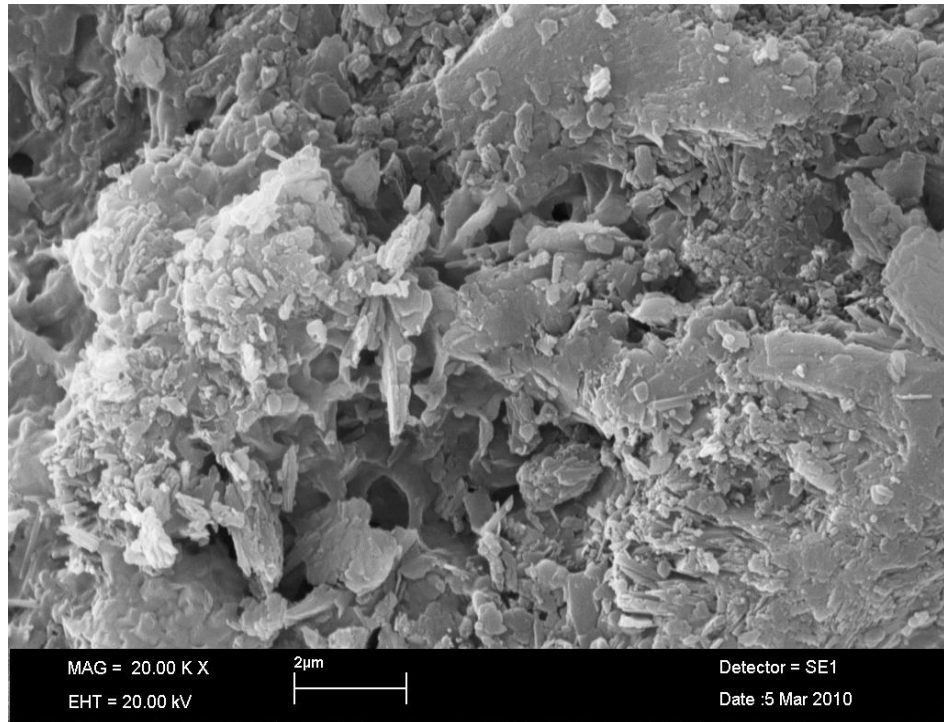
Şekil 5.6 Zeolit ile Ni(II)'nin adsorpsiyondan sonraki SEM görüntüsü
