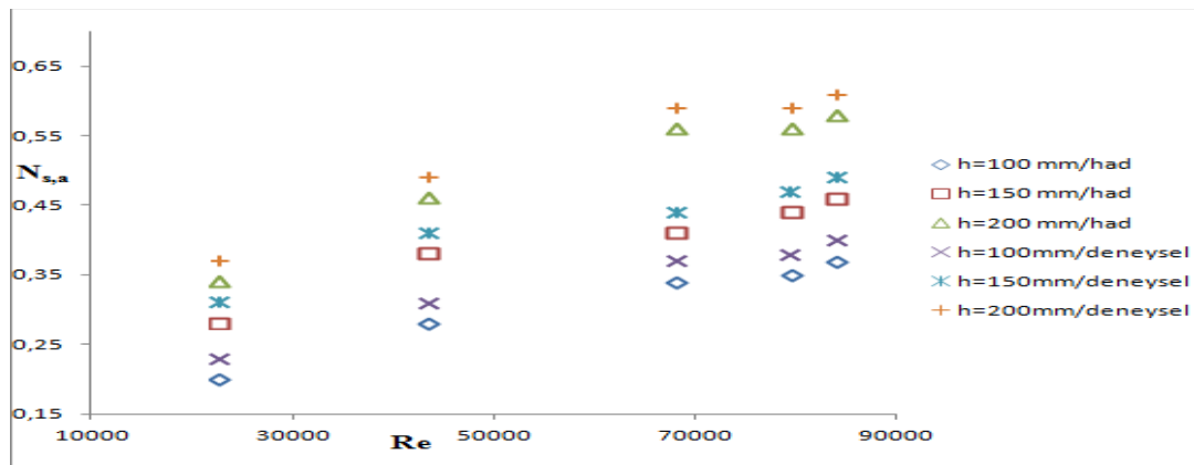
Şekil 4.37. OD-2 için sayısal analiz ve deneysel sonuçların karşılaştırılması
