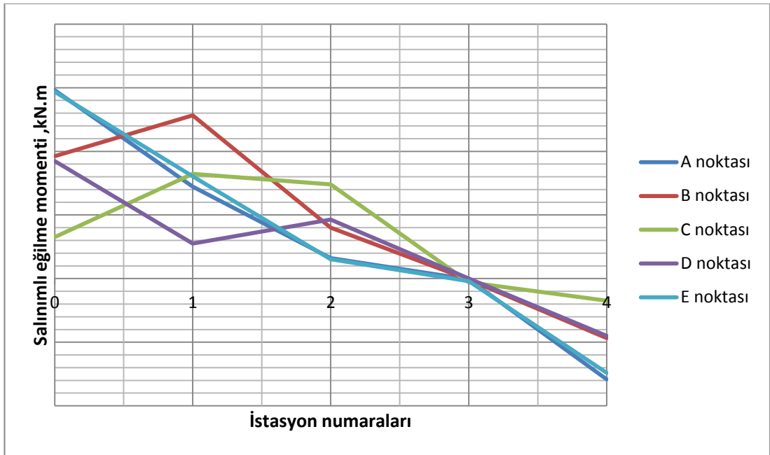
Şekil 4.9: Yatak bölgesinde A – E arasındaki noktaların 0 – 4 arasındaki istasyonlardan geçerken oluşan moment değerleri.
