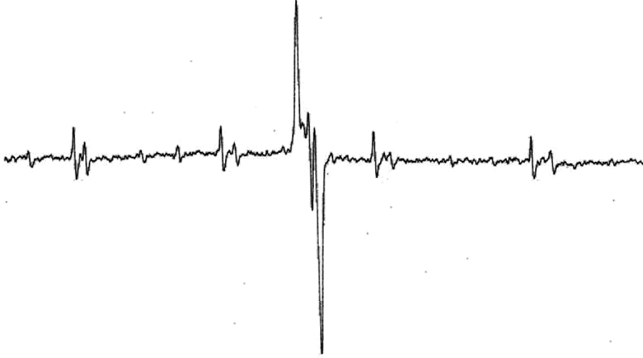
Şekil 4.6. K_2S_2O_5 tozunun 3 kGy dozda gama ışını ile ışınlanması sonucu elde edilen EPR spektrumu
