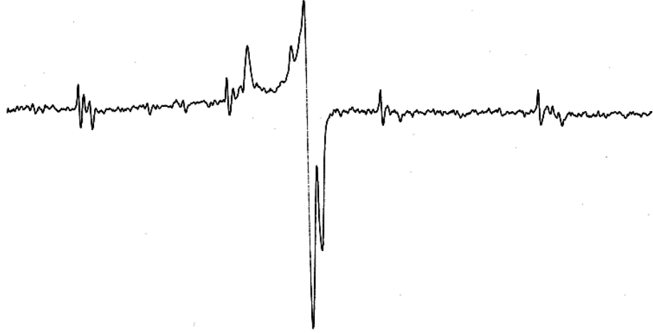
Şekil 4.9. K_2S_2O_8 in 3 kGy dozunda gama ışını ile ışınlanması sonucu elde edilen EPR spektrumu
