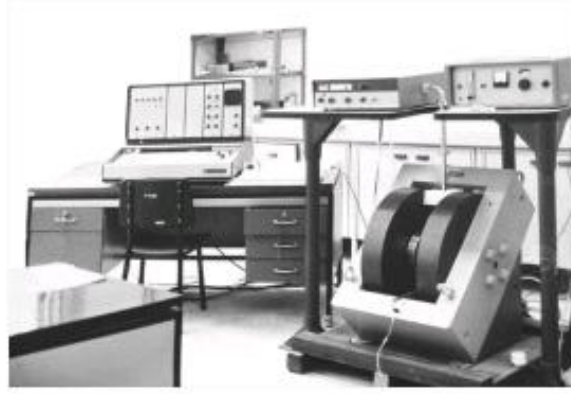
Şekil 3.2. Ondokuz Mayıs Üniversitesi Fizik Bölümü EPR laboratuvarında bulunan X-Band Varian Century Line Series E109 EPR spektrometresi
