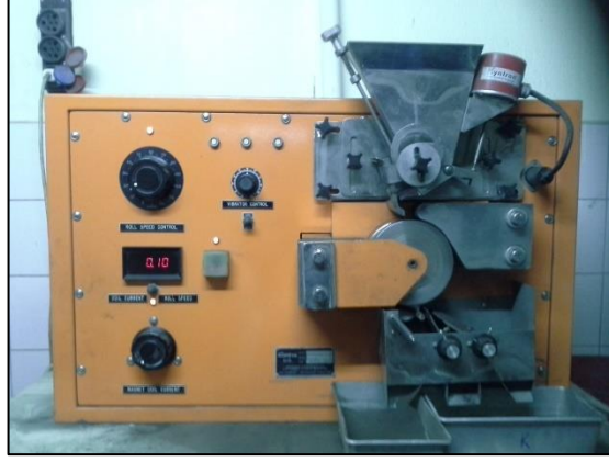
Şekil 4.5. Yüksek alan şiddetli kuru manyetik ayırıcı(Carpco Inc. MIH Marka)
