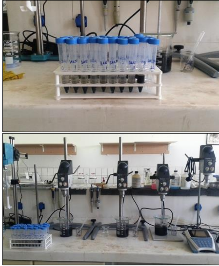
Şekil 4.9. Kinetik test deney düzeneği ve örnek tüpleri
