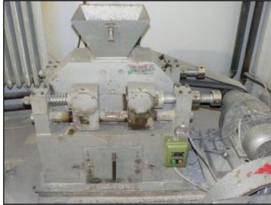
Şekil 4.3. Boyut küçültme işlemlerinde kullanılan merdaneli kırıcı
