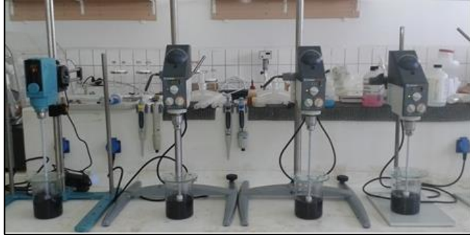
Şekil 4.10. Ana liç deneyleri 4'lü çalışma
