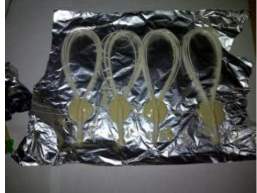
c. Yapıştırıcı uygulanmış membranların teflon hortuma geçirilerek kurumaya bırakılması.
