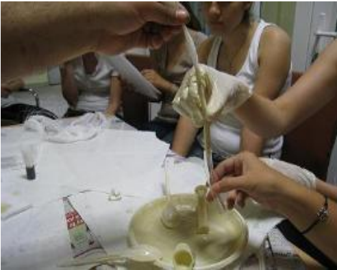
c. Yapıştırıcı uygulanmış membranların teflon hortuma geçirilerek kurumaya bırakılması.
