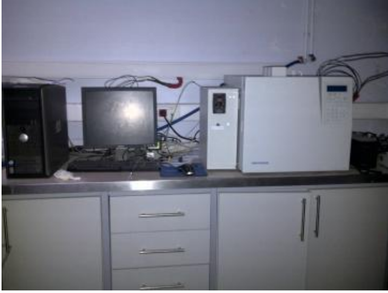
Şekil 3.4 : Perichrom P1525 marka GC cihazı.
