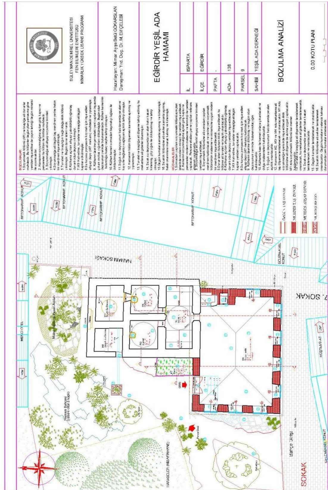
Şekil D.1. Eğirdir Yeşil Ada Hamamı'nın planı (bozulma analizi)
