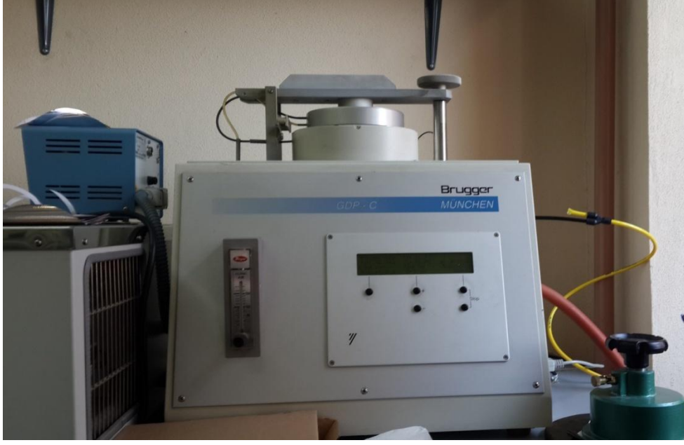
Şekil 2.2. ASTM D1434 yöntemine göre ölçüm yapan Gaz Geçirgenlik Test Sistemi Numunedeki kalınlık farklanmasını en aza indirmek için test örneğinin yüzey alanı bir yüzü yapışkanlı alüminyum folyo ile maskelenerek 9,73 \text{ cm}^2 'ye küçültülmüştür.
