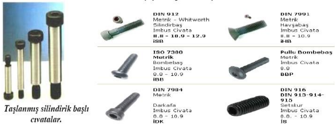
Şekil 5.9. Kalıp elemanlarının montajında kullanılan standart civatalar [FİBRO Kalıp Elemanları Kataloğu]
