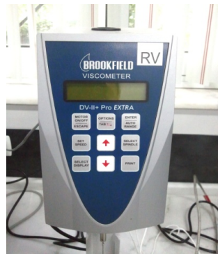
Şekil 3.12. “Brookfield DV-II+Pro EXTRA” RV Cihazının ana görüntüsü ve onun tüpü, silindirik mili ve teli(a), Cihazın ana ekranı (b), Brookfield termosel aleti (c).
