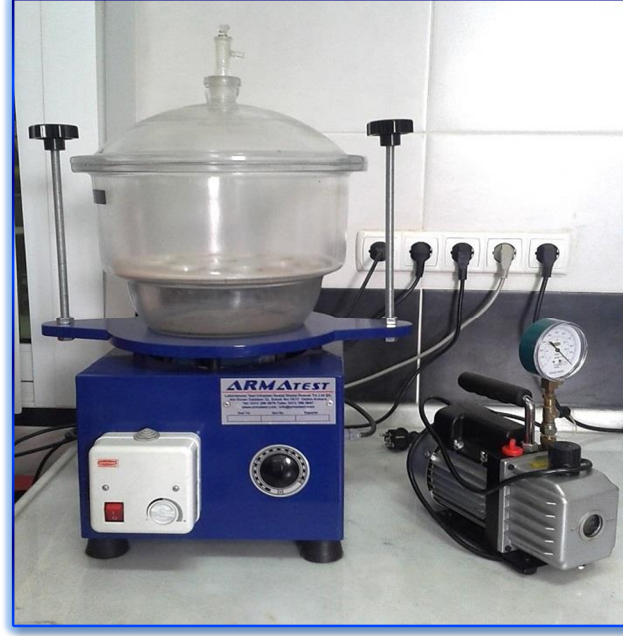
Şekil 5.10. Numunelerin manometre ile doygun hale getirilmesi.
