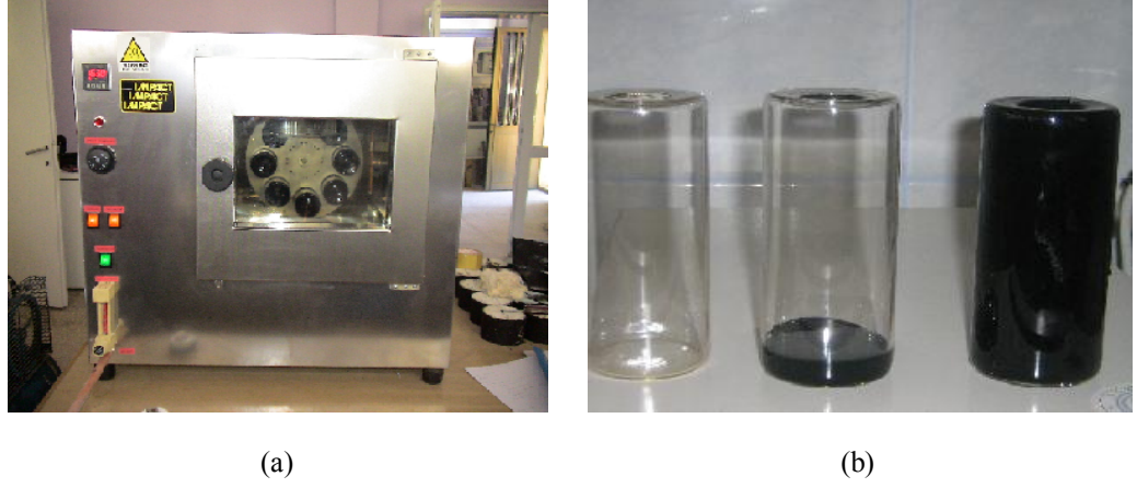
Şekil 5.6. RTFOT Deneyi yapılışı (a) ve şişelerin deneyden önceki ve sonraki görünüşü (b).
