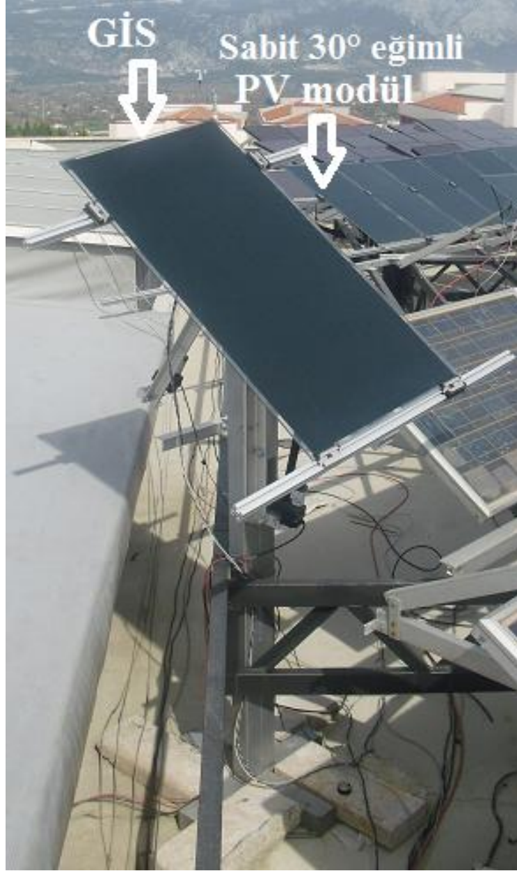
Şekil 5.6. Sabit 30° eğimli PV modül ile GİS
