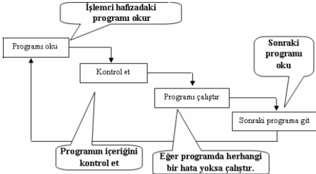
Şekil 4.2. PLC'lerin blok şeması
