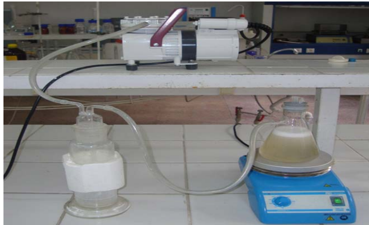
Şekil 3.2. Kaplama solüsyonundaki hava kabarcıklarının uzaklaştırılması
