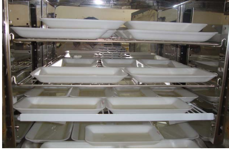
Şekil 3.4. Kuru havalı sterilizatörde filmlerin kurutulması
