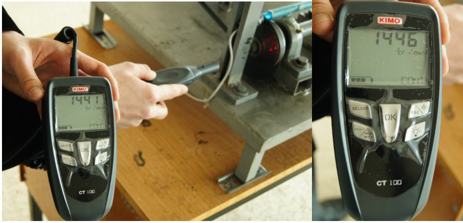
Şekil 3.13. Devir ölçer ile sistemin dakikadaki devir sayısının kontrolü
