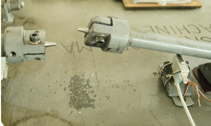
Şekil 3.14. Numunelerin kırılması ve devir ölçer durdurma anahtarı
