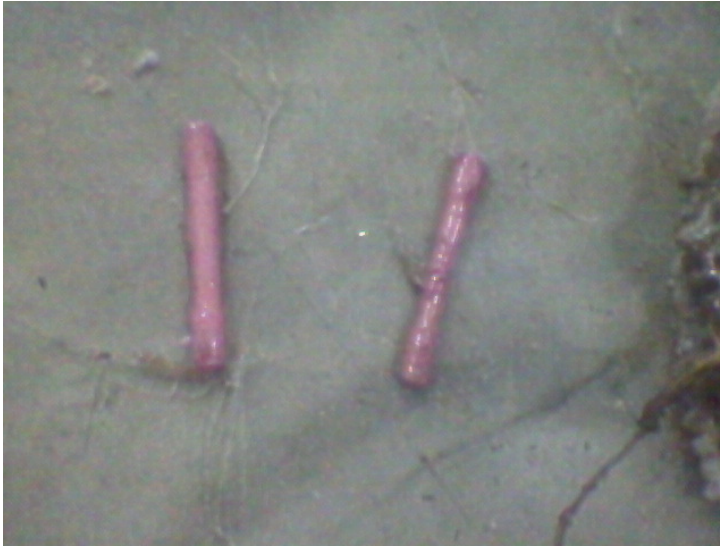
Şekil 3.8. Fırından çıkarılmış ve üzeri borik asit ile kaplanmış numuneler
