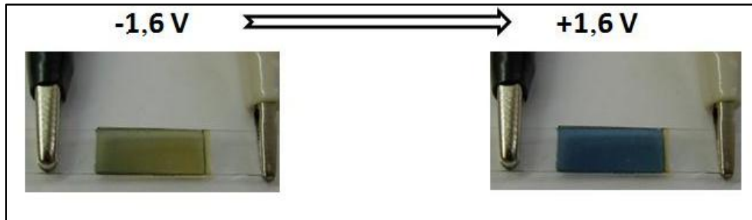
Şekil 5.11. P 2 /PEDOT elektrokromik cihazının renk değişimi
