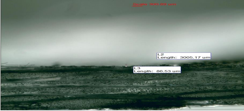
Şekil 4.11. Bir tur lazer işlemleri ile oluşan derinlik (0,086mm)
