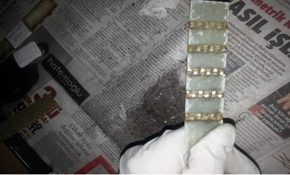
Şekil 4.8. Lazer ile kanal açılmış numunenin ön temizlik sonrası durumu
