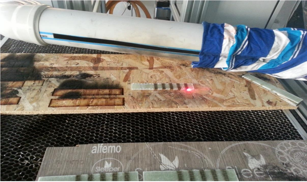
Şekil 4.5. CO 2 lazer tezgahı ile numune yüzeylerine kanalların açılması
