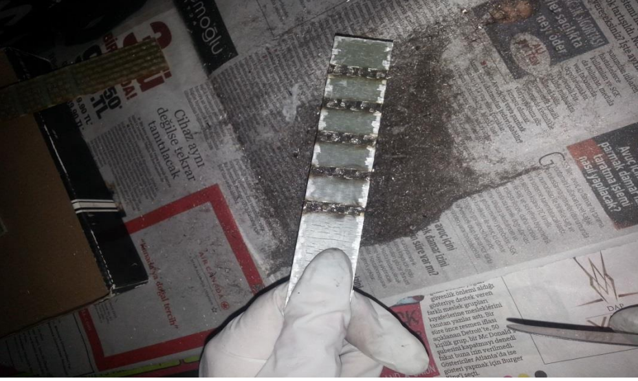
Şekil 4.7. Lazer ile kanal açılmış numunenin ön temizlik öncesi durumu
