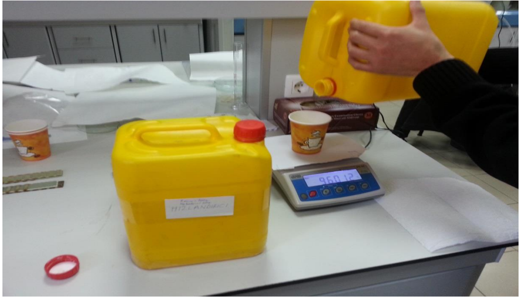
Şekil 4.14. Epoksi ve hızlandırıcının hassas kantar kullanılarak karıştırılması
