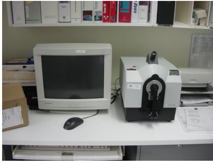
Şekil 6.2.3.1. Datacolor renk ölçüm cihazı
