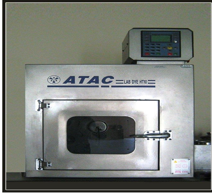
Şekil 6.2.1.1. Numune boyama makinası dış görünüşü.
