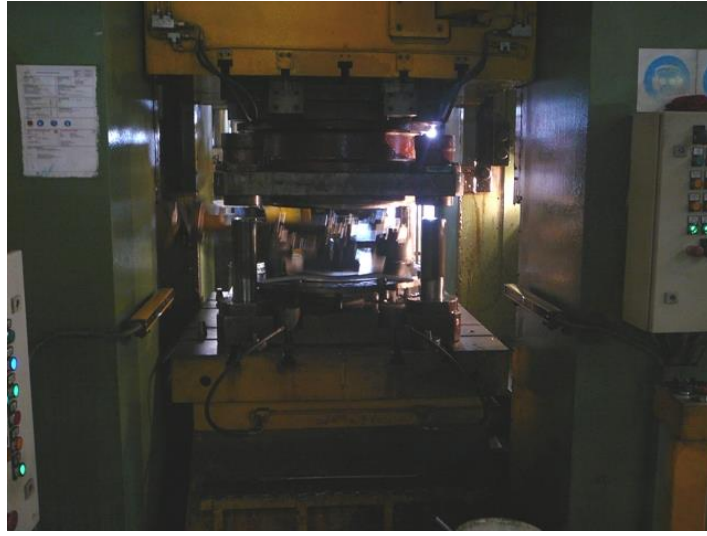
Şekil 2.10 Kulak kesim prosesi
