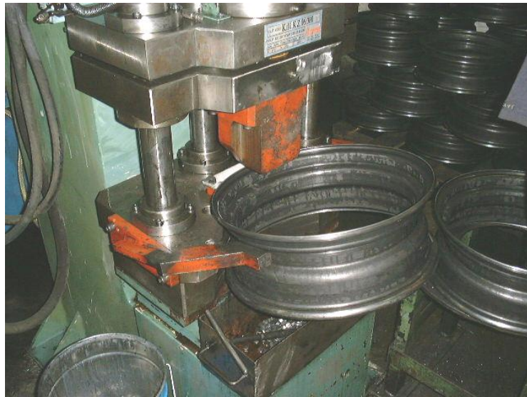
Şekil 2.9 Sübap delme ve ezme prosesi
