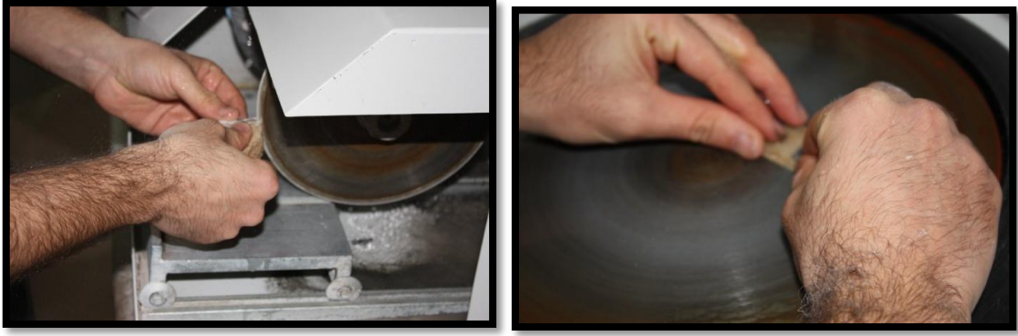
Fotoğraf 2.5 Numunenin kesilmesi ve demir tozu ile aşındırılması işlemi
