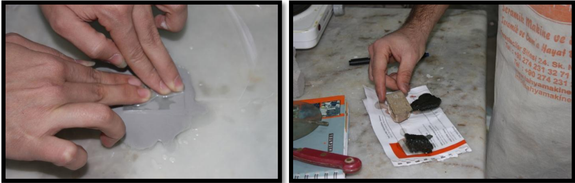
Fotoğraf 2.6 Numune yüzeyinin parlatılması ve numunenin lam'a yapıştırılması.
